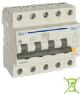
Ejemplo de utilización: cabecera de cuadros auxiliares de obra. Poder de corte 10kA. 240/415V AC. (50-60Hz). Utilizar pulsador de emergencia con contactos cerrados.
