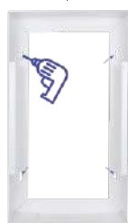
1- Fijar zócalo metálico a la pared
